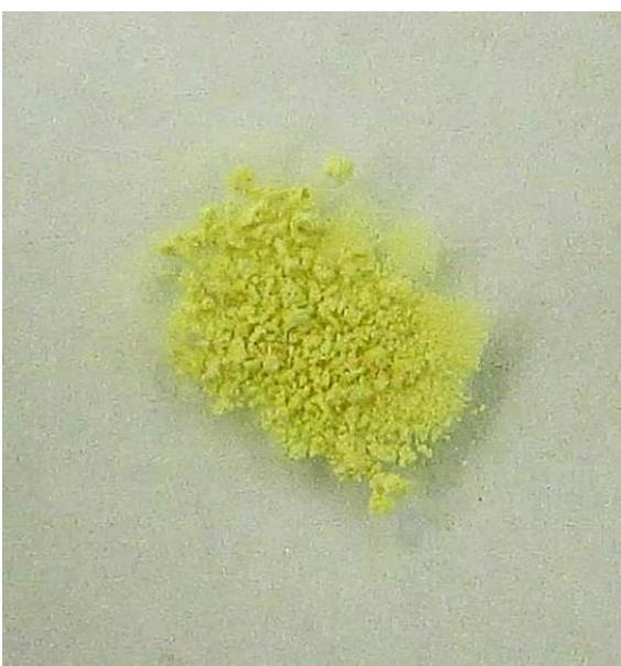
b) Imágenes de  $\text{Ho}_2\text{O}_3$  obtenido por descomposición térmica de  $\text{Ho}_2(\text{CO}_3)_3$ . A la izquierda el compuesto de color beige bajo la luz del sol y a la derecha el mismo compuesto, de color amarillo, bajo la luz de los fluorescentes del laboratorio.
