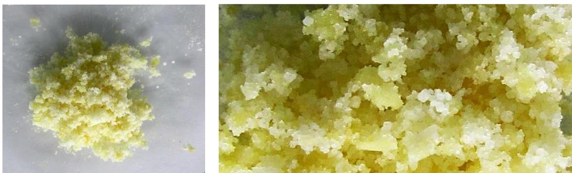
Aquí se ve el bonito color amarillo brillante del  $(\text{NH}_4)_3\text{HoCl}_6$ :
