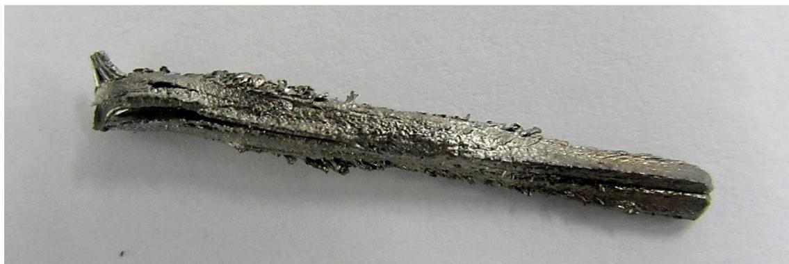
El metal es resistente y aunque es fino (1g en total) no se puede doblar. Se ha obtenido por el proceso de destilación, por lo que tiene un aspecto dendrítico<sup>8</sup>, como si se hubiera depositado en fibras. Según el texto de Patnaik es un metal blando, pero compacto y con una densidad de  $8.78 \text{ g/cm}^3$ , superior a la del hierro pero muy inferior a la de los metales nobles<sup>9</sup>.
