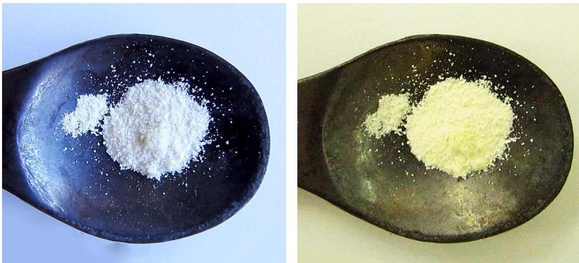
c) Imágenes de  $\text{Ho}_2\text{O}_3$  obtenido por descomposición térmica de  $\text{Ho}_2(\text{C}_2\text{O}_4)_3$ . A la izquierda, de color «tierra», bajo la luz del sol y a la derecha, de color ocre, bajo la luz de los fluorescentes del laboratorio.
