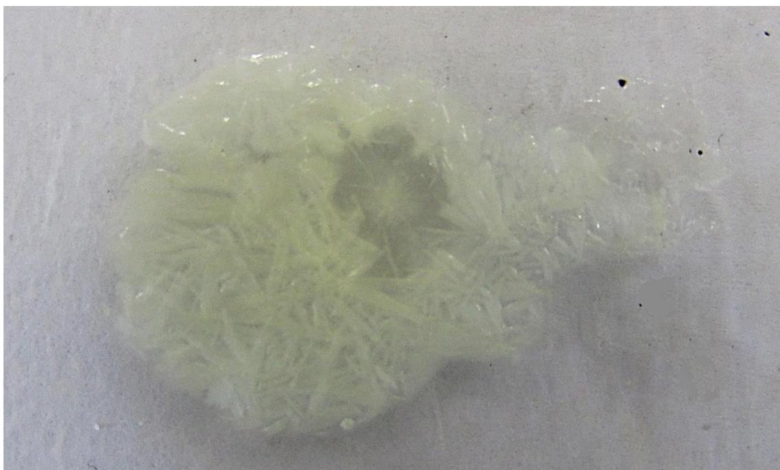
Tras volver a colocar el vidrio de reloj sobre la rejilla de amianto para eliminar el agua absorbida por deliquesencia vemos que los cristales de  $\text{H}_2(\text{SO}_4)_3$  han desaparecido y el compuesto se ha desestructurado. También merece la pena resaltar la variación de colores que aparecen en el compuesto, probablemente por diferencias en el grado de humedad o en el tamaño de partícula.
