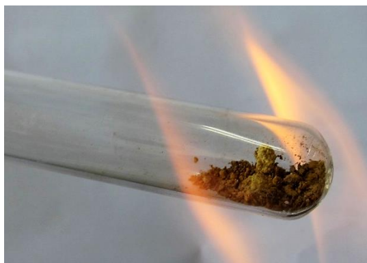
Oscurecimiento por descomposición del oxalato
