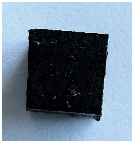
Metal tras permanecer en ácido diluido
