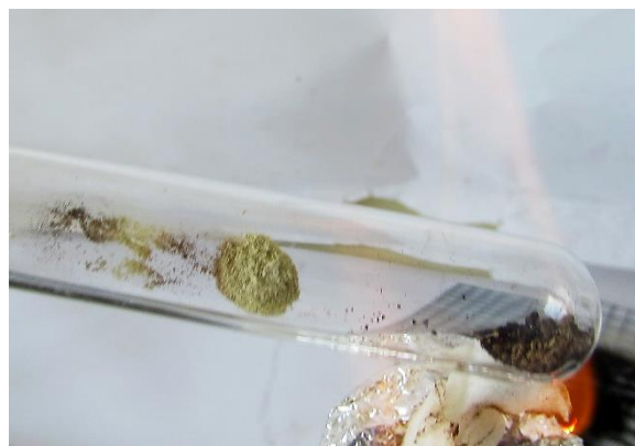
Aparecen dos colores ( \text{Pr}_2\text{O}_3 y \text{Pr}_6\text{O}_{11} )
